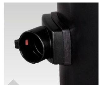
3-Filterreinigung Der Luftpfeingang ist tangential angebracht, um die Zyklonwirkung (Schmutzvorabscheidung) zu unterstützen
