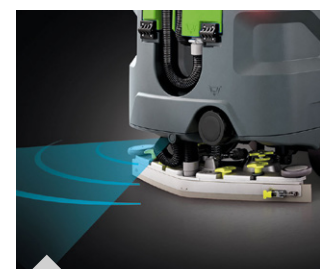
Kollisionsschutzsystem warnt bei Rückwärtsfahrt vor Hindernissen
