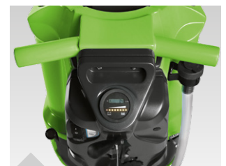
Mechanische Bedienung von Bürste und Absaugleiste über Hebel
