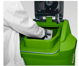
Frischwassertank mit Schlauch für Schnellbefüllung
