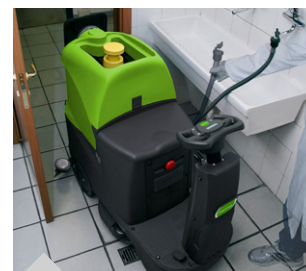
Frischwassertank mit Schlauch für Schnellbefüllung
