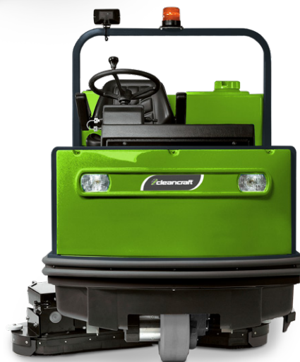
Reinigungsbürsten mit automatischem Einzug bei Stößen
