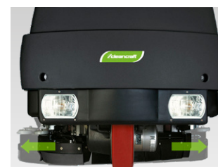
Reinigungsbürsten mit automatischem Einzug bei Stößen
