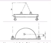
raverse und Last nehmen nach einer Hubbewegung eine Gleichgewichtslage ein. Traversen mit langer Aufhängung bieten eine größere Stabilität.
