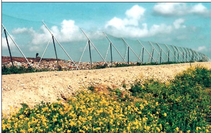
Abb. 1: mobile Fangzaunanlage, einfache Ausführung; Höhe 4 m; bis 70 km/h Windgeschwindigkeit
