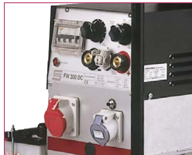
SEB 250XE Anschlüsse mit Dinse-Anschlussbuchsen für Stecker 35/50 mm 2
