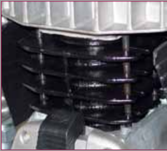
Stark auch im Detail: Gusszylinder WERKER 315
