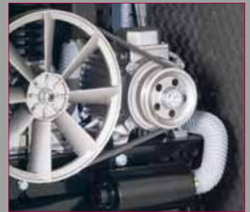
Erhöhte Betriebssicherheit durch Indirektantrieb
