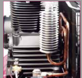
Profi-Line: Kühler aus Alu- Druckguss
