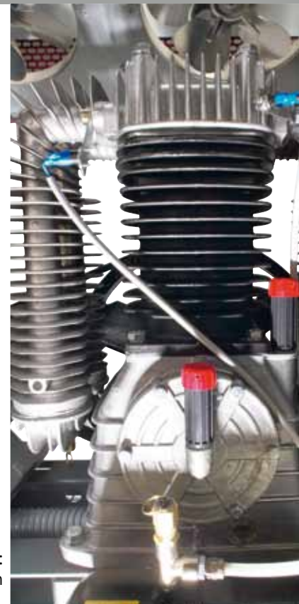
Funktionale Ästhetik: großflächige Kühlrippen
