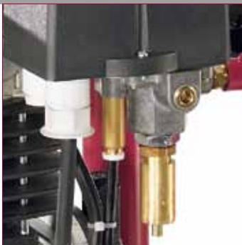
Sicherheitsventil und Druckentlastungsventil
