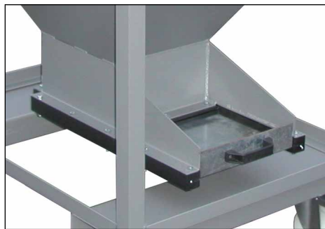
Schieberverschluss (SR-D, SG-D, SRE-D)
