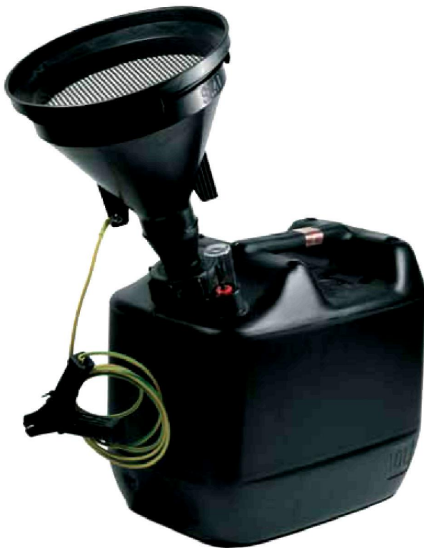
Sicherheits-Entsorgungs-Set 3 bestehend aus: Kanister (Gewinde S60), 10 Liter PE-HD leitfähig mit mechanischer Füllstandskontrolle, Sicherheitstrichter PE-HD leitfähig mit Edelstahl-sieb und Erdungskabel Bestell-Nr. 16977
