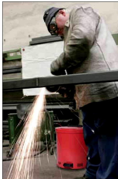
Sicherheit am Arbeitsplatz: generell selbstschließender Deckel verhindert eine Entzündung des Inhaltes z.B. durch Funkenflug
